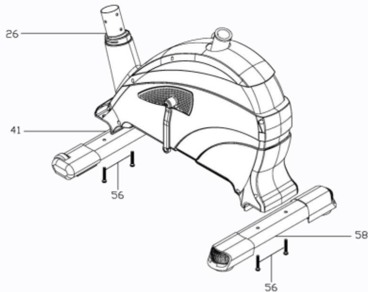
Vezměte přední stabilizátor (41) a zadní stabilizátor (58). Zatímco někdo jiný zvedne přední / zadní část rámu, připevněte přední / zadní stabilizátor na rám (26) pomocí šroubů (56).
