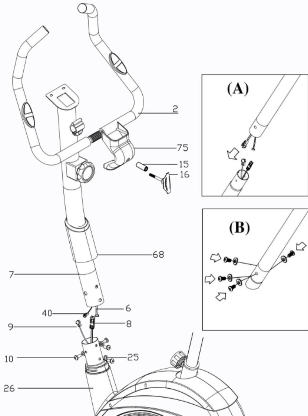
Zatímco vám někdo přidržuje přední řídítkovou část ve vzpřímené poloze, připojte prostřední kabely (40) k dolním kabelům (9). Opatrně zasuňte sloupek rukojetí (7) do rámu (26). Dávejte pozor, abyste nepřerušili spoj kabelů. Připevněte sloupek rukojetí k rámu pomocí 4 šroubů M8 (10) a 4 podložek M8 (25).
